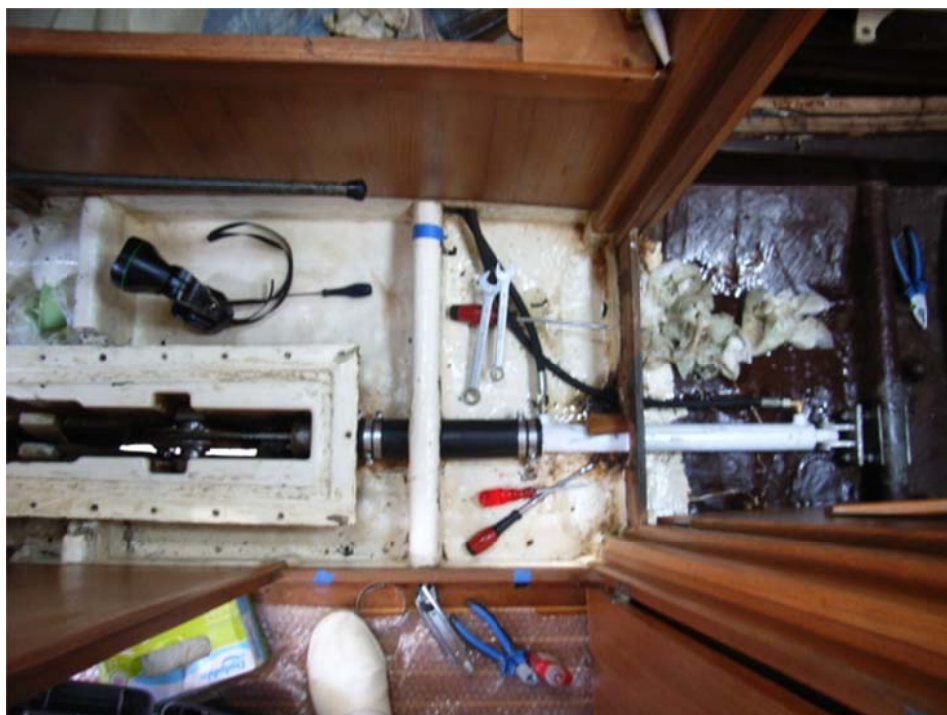
Dérive : réfection vérin, glissières
